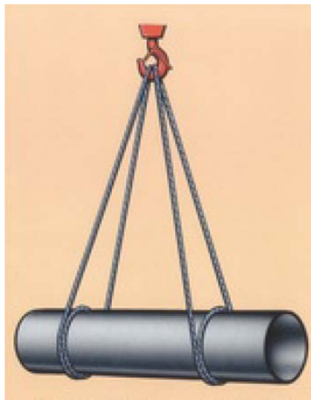
Рис. 30. Два кольцевых стропа обкручивания
