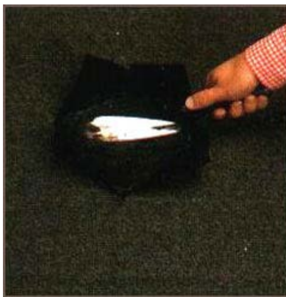
Рис. 100. Нанесение мастики на заплату для наклейки отогнутых концов ткани
