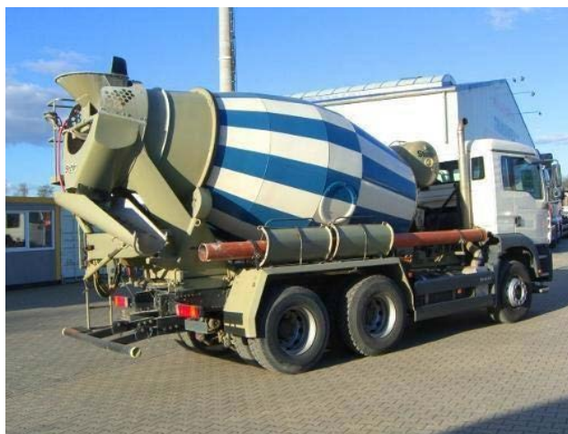
Рис. 56. Бетоновоз с кузовом бункерного типа
