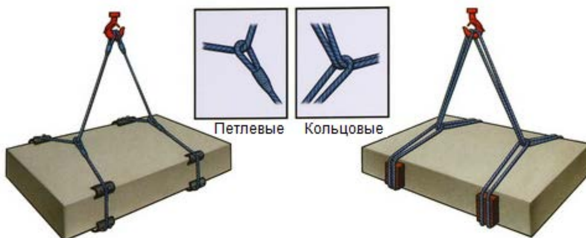
Рис. 35. Схемы строповки прямоугольной плиты «на удавку» и расположения проставок
