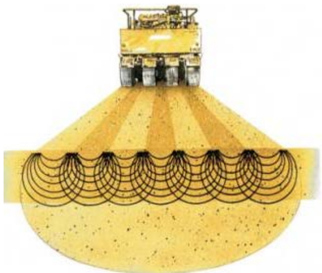
Рис. 126. Перекрывание лукович нормальных вертикальных напряжений
