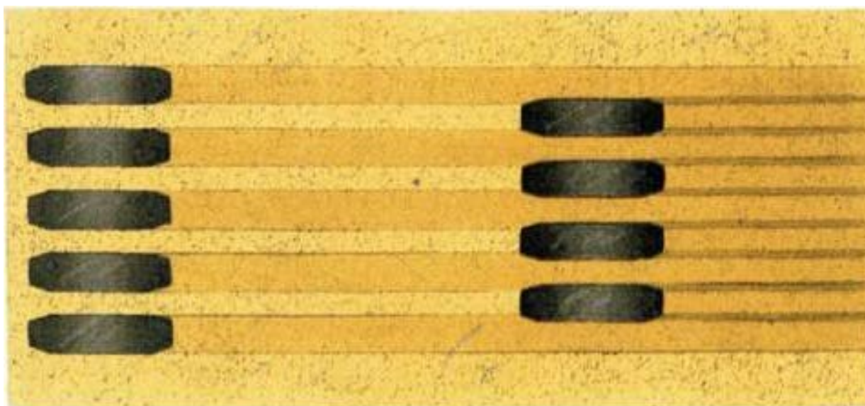
Рис. 125. Схема перекрытия проходов колес переднего и заднего валцов самоходных катков на пневматических шинах
