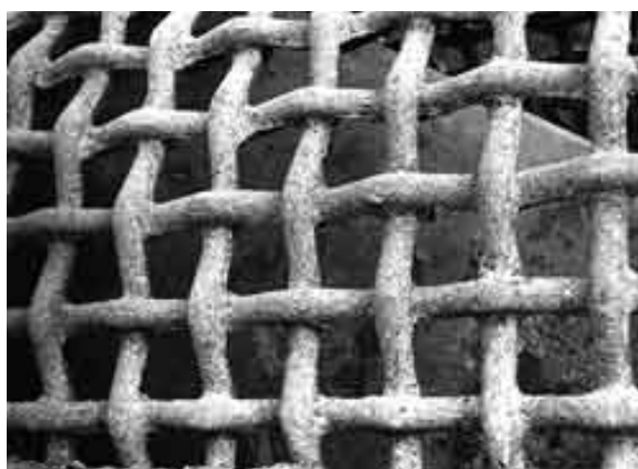
Рис. 119. Фрагмент вальца решетчатого катка
