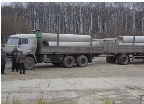
Рис. 36. Транспортирование звеньев седельным тягачом
