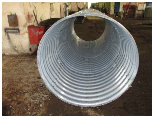
Рис. 80. Концевая секция трубы из четырех звеньев
