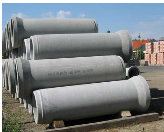
Рис. 39. Хранение звеньев в штабеле на ЗЖБИ
