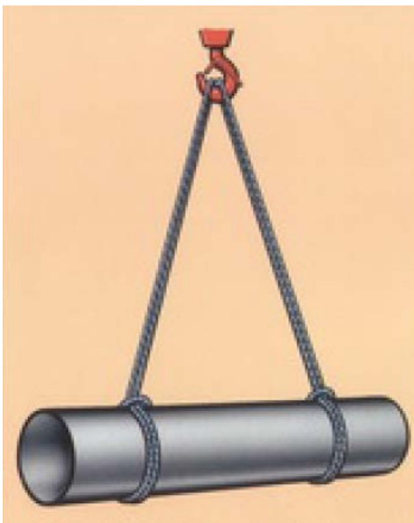
Рис. 32. Два кольцевых стропа двойной удавки
