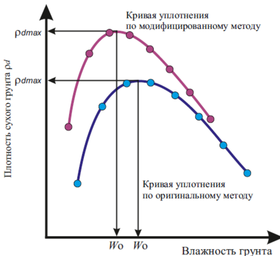
Рис. 122. Определение максимальной плотности по оригинальному и модифицированному Проктор-тесту
