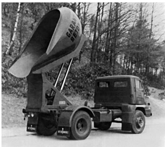
Рис. 55. Бетоновоз с кузовом ковшового типа
