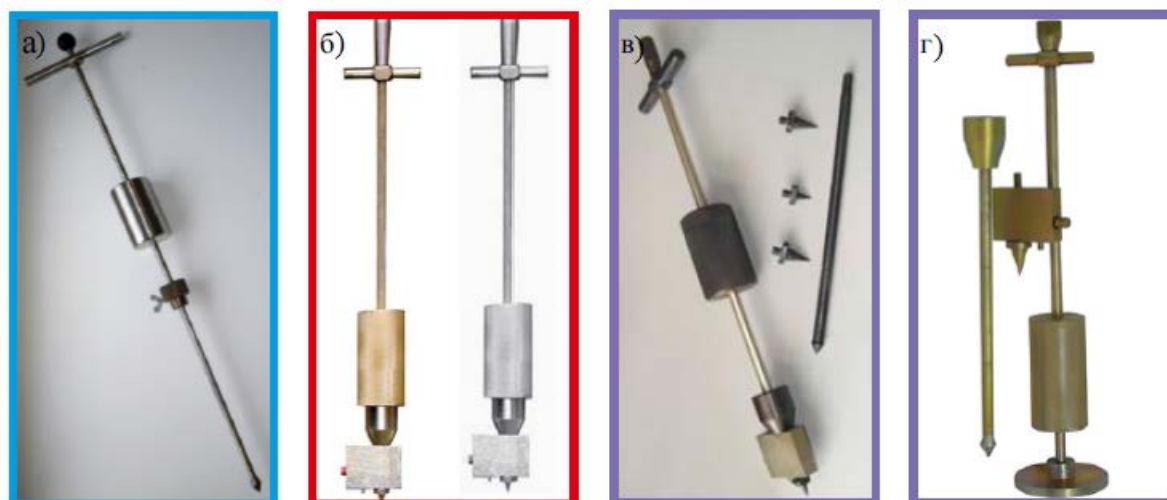
Рис. 132. Динамические плотномеры-пенетрометры: а – РМ-1; б – ДПА-1; в – КП-150; г – ДПУ
