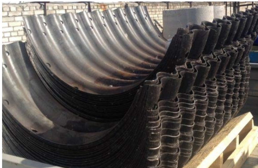
Рис. 77. Листы металла с отверстиями под болтовые соединения
