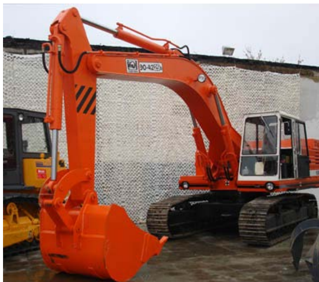
Рис. 41. Общий вид экскаватора ЭО-4225А-07 (ковш обратная лопата V = 0,65 - 1,42 \text{ м}^3 )
