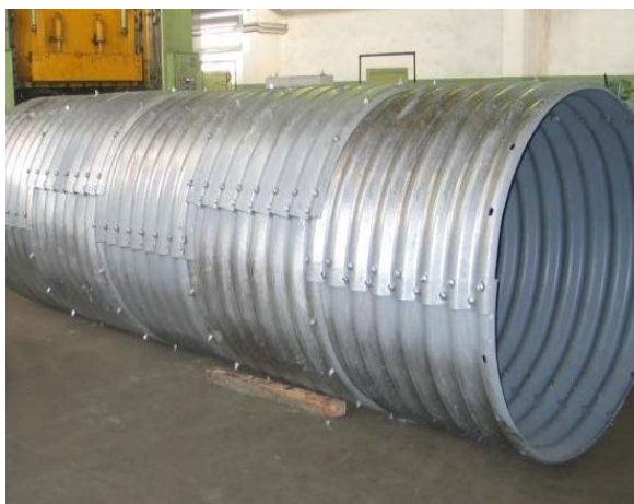
Рис. 79. Промежуточная секция трубы из пяти звеньев
