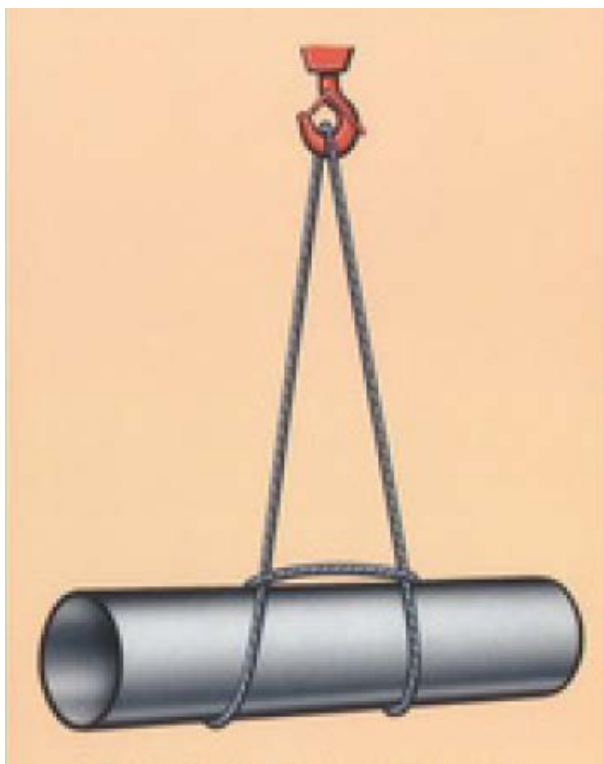
Рис. 31. Универсальная кольцевая стропа (двухконцевая удавка)
