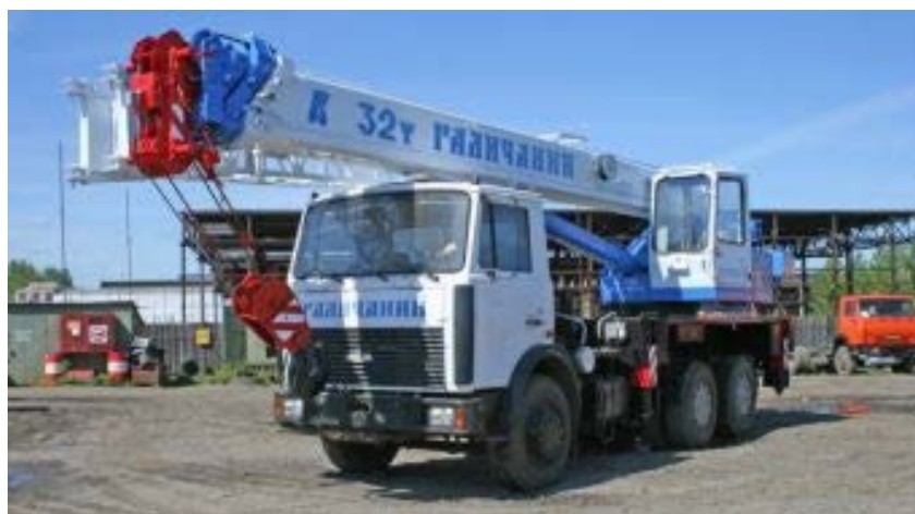
Рис. 72. Автомобильный кран «Галичанин» КС-55729В грузоподъемностью 32 т
