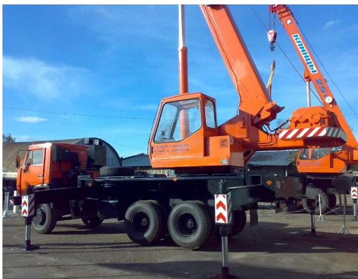
Рис. 74. Автомобильный кран КС-55713-1К-3, установленный на выносные опоры
