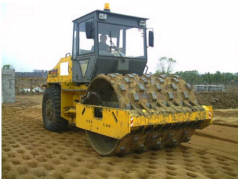
Рис. 127. Иллюстрация внедрения кулачков в слой уплотняемого грунта
